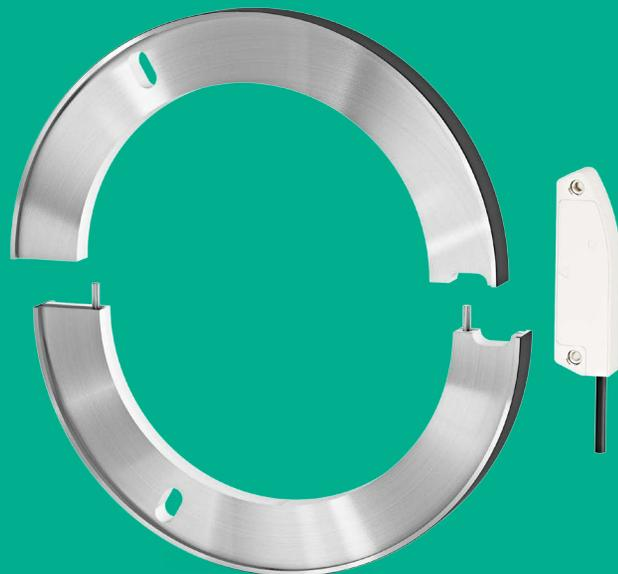
L'encoder assoluto senza cuscinetti SMLA è facile da montare su alberi di grande diametro in aree difficilmente accessibili. SMLA si caratterizza per l'abbinamento all'anello segmentato MRA/262 che è espressamente progettato in **due parti distinte** per semplificare l'installazione in alberi di grande diametro fino a 190 mm dove risulti problematico l'accesso per il montaggio o la manutenzione.
