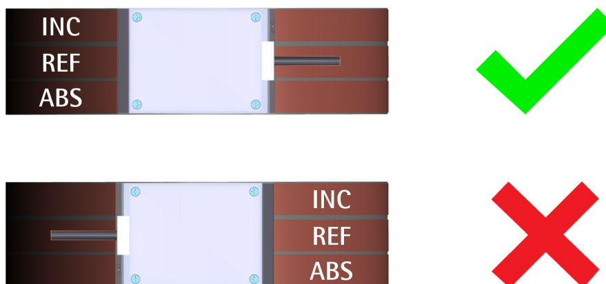
Figura 5 - Direzione di montaggio del sensore
