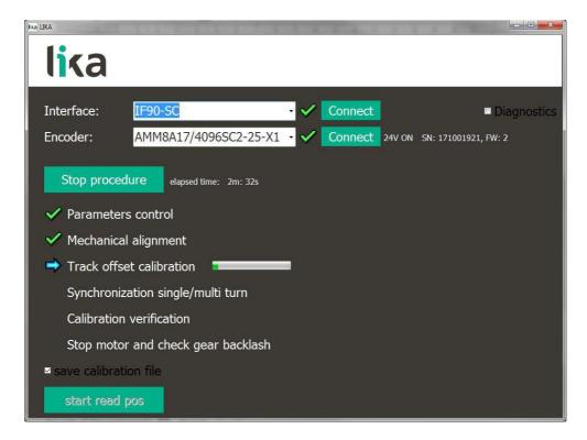
Non appena la procedura di calibrazione è stata completata con successo, un segno di spunta verde ( comparirà a fianco dell'elemento Track offset calibration e il programma avvierà automaticamente la fase successiva.
