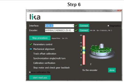
E' ora necessario allineare il corpo encoder 5 con il disco 3. Per informazioni complete sull'allineamento meccanico, la procedura di calibrazione e l'operazione di sincronizzazione mediante l'utilizzo del programma IF90-SC, riferirsi alla sezione "6 - Procedura di calibrazione e sincronizzazione" a pagina 31.
