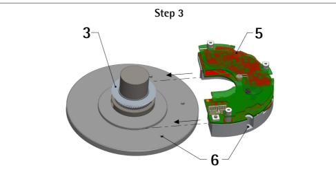
Far scivolare il corpo encoder **5** sopra il disco **3** fino a far corrispondere i fori per le viti **6**; assicurarsi che la custodia metallica del corpo encoder **5** non vada a toccare il disco **3**; maneggiare sempre il corpo encoder **5** afferrando la custodia metallica per i bordi esterni.
