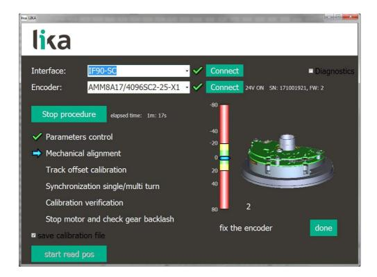
Se l'encoder non è allineato correttamente sul disco, l'indicatore di riferimento sulla barra verticale con scala numerica si andrà a posizionare nelle sezioni rosse in alto o in basso; inoltre sopra l'immagine dell'encoder apparirà una freccia gialla a due punte. In basso si visualizza lo scostamento dal valore ideale.
