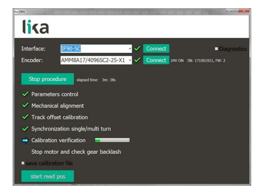
Non appena la procedura di verifica della calibrazione è stata completata positivamente, un segno di spunta verde ( comparirà a fianco dell'elemento Calibration verification; con questa operazione ha termine il controllo software sulla corretta installazione e calibrazione dell'encoder AMM8A e l'operatore deve arrestare il motore.
