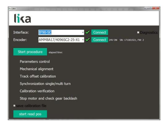
Se il programma non è in grado di stabilire una connessione con l'interfaccia IF90-SC, una rossa compare a fianco dell'elemento **Interface** accompagnata dal messaggio **IF90 not connected** (si veda a pagina 44). Premere il pulsante **CONNECT** per ritentare la connessione. Se ancora non è possibile, verificare che l'interfaccia IF90-SC sia collegata correttamente e alimentata. Assicurarsi che la tensione di alimentazione sia corretta. Per ogni informazione riferirsi alla
