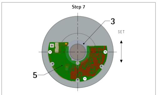
Correggere la posizione del corpo encoder **5** fino a che si trovi ben allineato sopra il disco **3** e sulla pagina dell'interfaccia di calibrazione compaia il messaggio **Fix the encoder** (si veda la Figura nel precedente **Step 6**).
