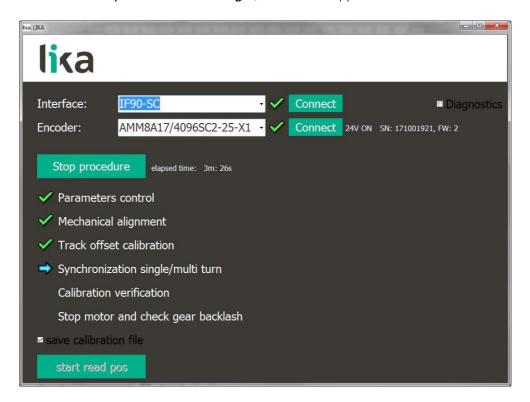
Non appena la procedura di sincronizzazione mono/multigiro è stata completata positivamente, un segno di spunta verde ( comparirà a fianco dell'elemento Synchronization single/multi turn e il programma avvierà automaticamente la fase successiva.
