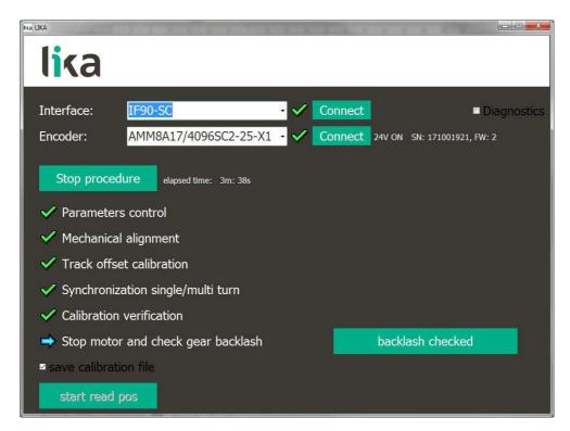
Per controllare la corretta rotazione degli ingranaggi e la presenza di un gioco ottimale l'operatore deve arrestare il motore e far ruotare manualmente l'ingranaggio affidandosi alla propria sensibilità ed esperienza nel cogliere movimento fluido e oppure regolare la presenza di eventuali impuntamenti.
