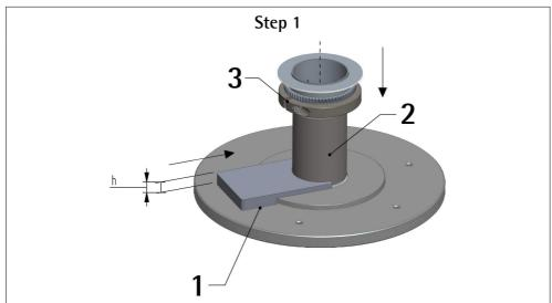
Posizionare il distanziale **PF5013 1** portandolo in battuta contro l'albero del motore **2**. Inserire il disco **3** nell'albero del motore **2** e portarlo in appoggio sul distanziale **1**; maneggiare sempre il disco **3** afferrandolo per la ghiera.
