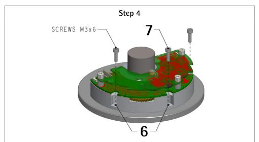
Inserire le tre viti a testa cilindrica tipo M3 x 6 7 nei fori 6, non stringerle, ma avvitarle appena leggermente di modo che il corpo encoder 5 possa muoversi. Assicurarsi che il corpo encoder 5 non possa muoversi su e giù.
