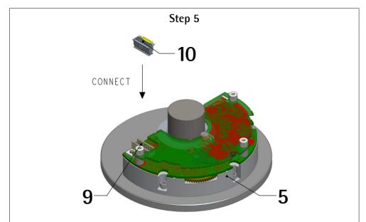
Collegare il cavo EXC-D15M-S71-A16-1,0-FCI-S71 10 al connettore 14 pin maschio 9 del corpo encoder 5 da un lato, al connettore dell'interfaccia dall'altro.
