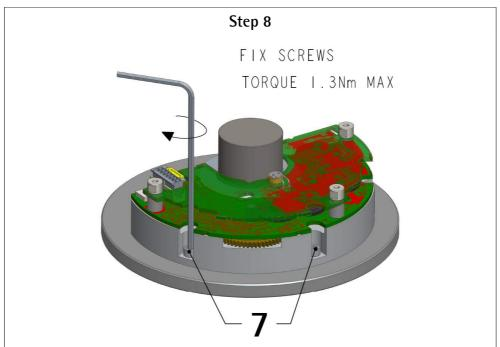
Stringere le tre viti **7** fissando saldamente il corpo encoder **5**, coppia di serraggio massima **1,3 Nm**. Tenere fermo il corpo encoder **5** ed evitare qualsiasi movimento durante il fissaggio. Premere infine il pulsante **DONE** nella pagina dell'interfaccia di calibrazione e sincronizzazione.
