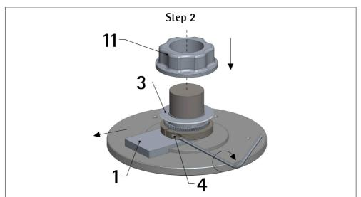
Utilizzare il tool di posizionamento **PF5015 11** per aiutare la discesa del disco **3** sul distanziale **PF5013 1**. Stringere la vite tipo M2 x 12 DIN 912 **4** fino a che il disco **3** sia fissato saldamente; assicurarsi che il disco **3** sia perfettamente appoggiato sul distanziale **1** prima di fissarlo; la coppia di serraggio massima è di **0,45** Nm.
