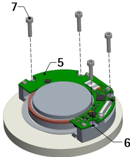
Inserire le quattro viti a testa cilindrica M3 x 16 min. UNI5931 **7** nei fori **6**, avvitare le viti **7** fino a fissare saldamente il corpo encoder **5**, coppia di serraggio massima **1,3 Nm**. Tenere fermo il corpo encoder **5** ed evitare qualsiasi movimento durante il fissaggio.
