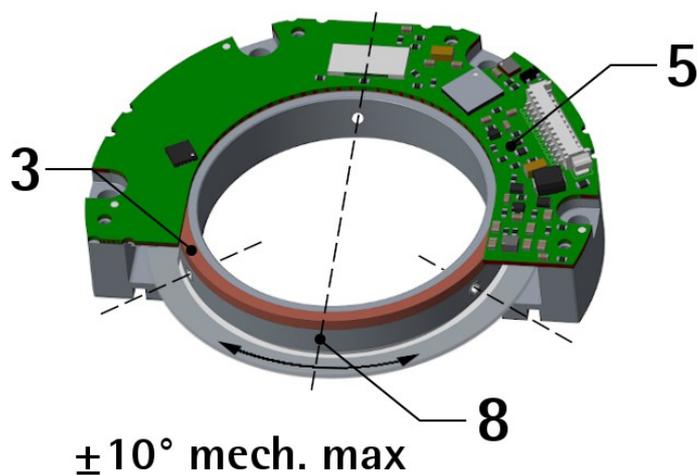
Ruotare l'albero del motore fino a che il disco **3** si trovi allineato rispetto al corpo encoder **5** come mostrato nella Figura; la bulinatura **8** presente sul disco **3** deve trovarsi centrata rispetto al corpo encoder **5** come mostrato nella Figura. Disallineamento massimo consentito:  $\pm 10$  gradi meccanici.
