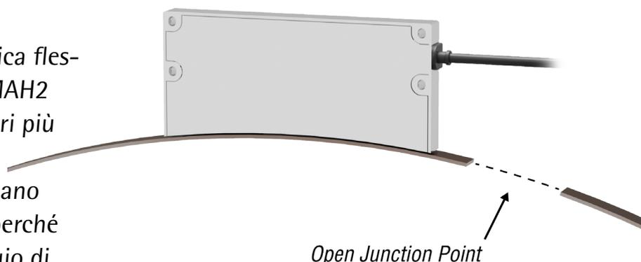
L'encoder assoluto bearingless SMAH2 è progettato per operare su alberi di grandi dimensioni con diametro fino a 2,6 m. Viene abbinato a una banda magnetica che deve essere fissata intorno all'albero. La banda può avere uno sviluppo fino a 8,1 m, secondo necessità, e ha una larghezza di soli 10 mm.
