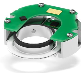
AMM5B è realizzato in un package frameless compatto e sottile (lo spessore è inferiore a 15 mm) ed è ideale per **l'installazione in spazi ristretti**.
