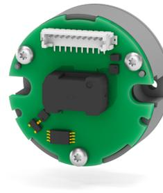
AMM33 è ideale per motori e applicazioni robotiche grazie alla **tecnologia Energy Harvesting** e al range esteso della temperatura operativa ( $-40^{\circ}\text{C} + 115^{\circ}\text{C}$ ).
