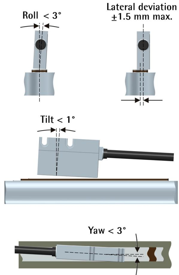
Figura 2 - Tolleranze montaggio sensore/banda
