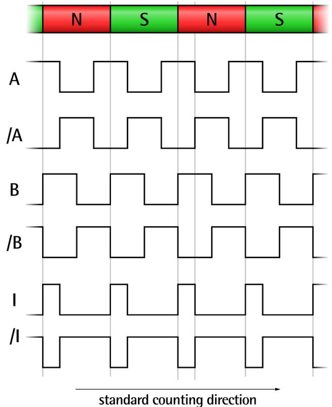
Figura 5- Esempio con fattore di interpolazione x4
