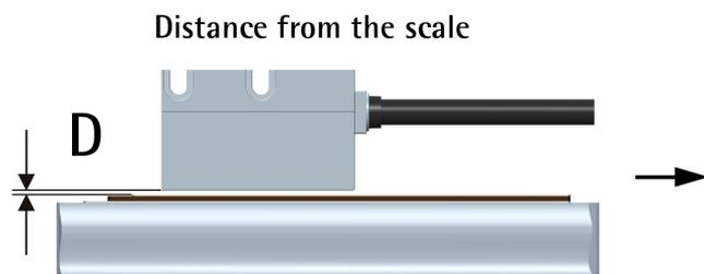
Figura 1 - Distanza montaggio sensore / banda
