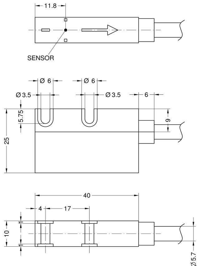
**3.2 Montaggio sensore con banda magnetica MTI**
