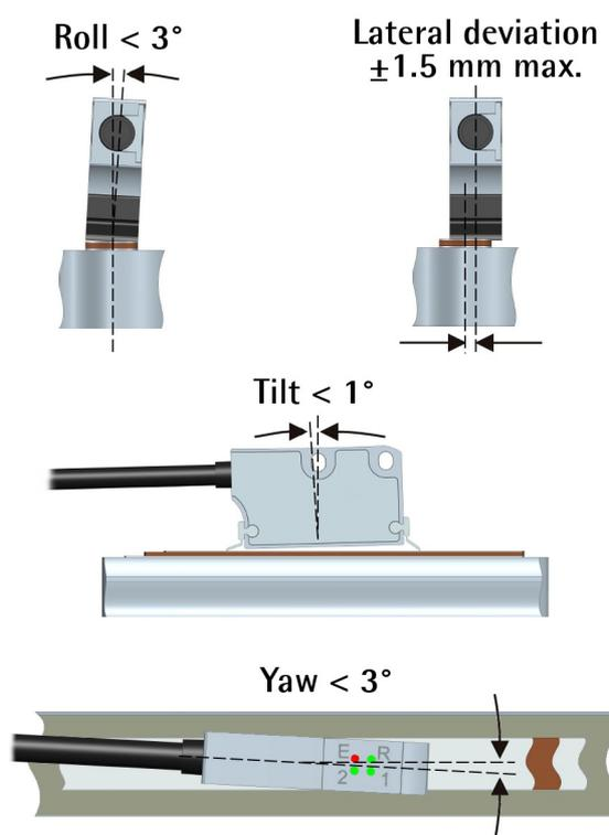
Figura 2 - Tolleranza di montaggio sensore / banda
