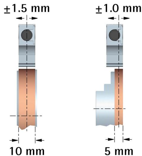
Figura 5 - Allineamento sensore / anello
